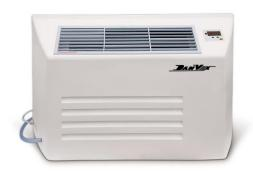
144 л/сутки Максимальное осушение Температурный диапазон от +10 до +32 °C Диапазон относительной влажности 40 - 100 % Выход воздуха 750 м3/ч 220/1~/50 В/Гц Электропитание Потребляемая мощность 1,69 кВт Габариты (ВхДхШ) 780х1360х270 мм Bec 95 кг
