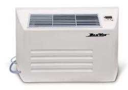
Максимальное осушение 100 л/сутки Температурный диапазон от +10 до +32 °C Диапазон относительной влажности 40 -100 % Выход воздуха 500 м3/ч Электропитание 220/1~/50 В/Гц Потребляемая мощность 1.26 кВт Габариты (ВхДхШ) 780x1180x270 мм Bec 55 кг
